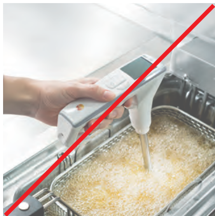
Рис. 30: Неправильная процедура измерения В масле присутствуют продукты для жарки
