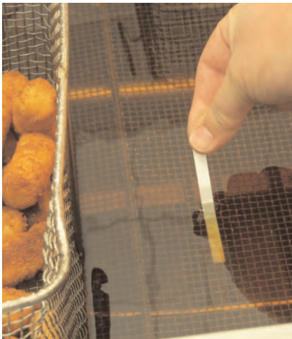
Рис. 22: Измерение свободных жирных кислот с использованием индикаторных полосок
