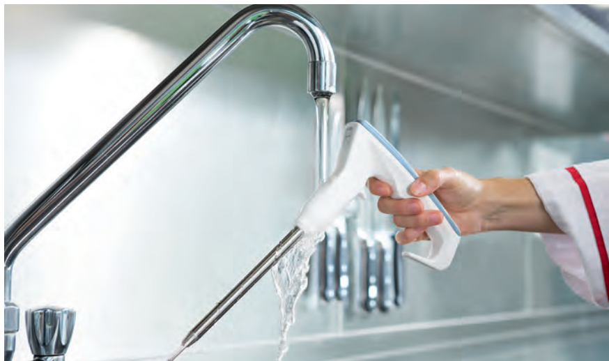
Рис. 28: Тестер масла для фритюра имеет класс защиты IP65, что означает, что его можно мыть под проточной водой после измерения.
