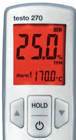
Рис. 26: Оптический и звуковой сигнал тревоги при превышении предельных значений
